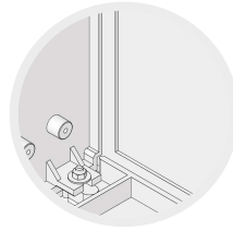
Typ B (brak izolatora na plecach) Type B (no insulator in the back wall) Typ B (kein Isolator auf der Rückseite) Тип B (отсутствие изолятора на задней стене корпуса)
