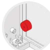
Izolator [F4] z otworem ø4 służący do montażu elementów za pomocą wkrętów
