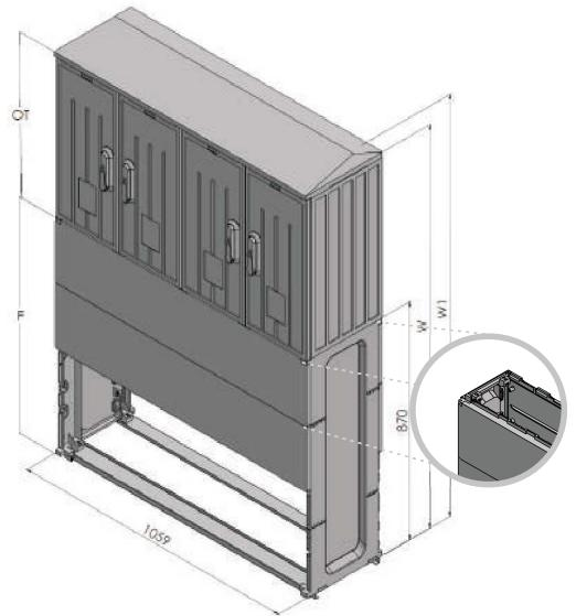
Enclosures width 106 cm (OT3 10w.4-2/2/2/2) / Gehäuse mit der breite 106 cm (OT3 10w.4-2/2/2/2) / Корпуса шириной 106 см (OT3 10w.4-2/2/2/2)
