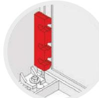
Izolator [G] odlewany na boku obudowy, umożliwia mocowanie szyn do boku obudowy
