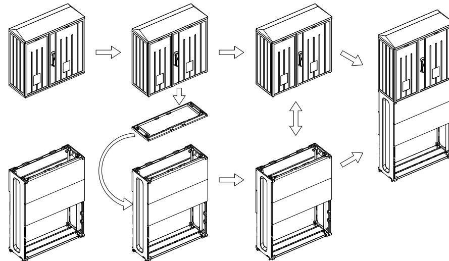
**Obudowa OT3 + Kieszeń fundamentu OT3 FKO + Fundament OT3 F**
