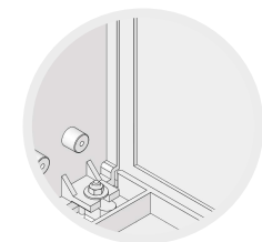
Typ B (brak izolatora na plecach) Type B (no insulator in the back wall) Typ B (kein Isolator auf der Rückseite) Тип B (отсутствие изолятора на задней стене корпуса)
